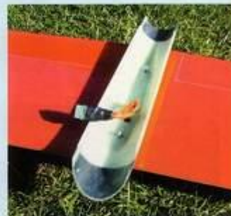
Das Flächenmittelstück ist mit dem Rumpfteil verschraubt
