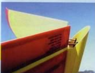
Gut geschützt: die V-Leitwerksanlenkung
