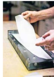
... die Leitwerksform wird mit Glasfaser beschichtet.
