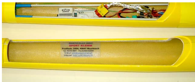
Rumpfhaube mit Bandtaschen fixiert. Rumpfausschnitt mit Bandtasche vorne und hinten. Rumpfausschnitt im Lieferzustand.
