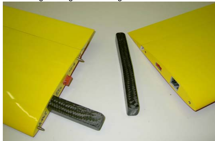
Flächensteckung mit 16x20mm – CFK - Kohleverbinder
